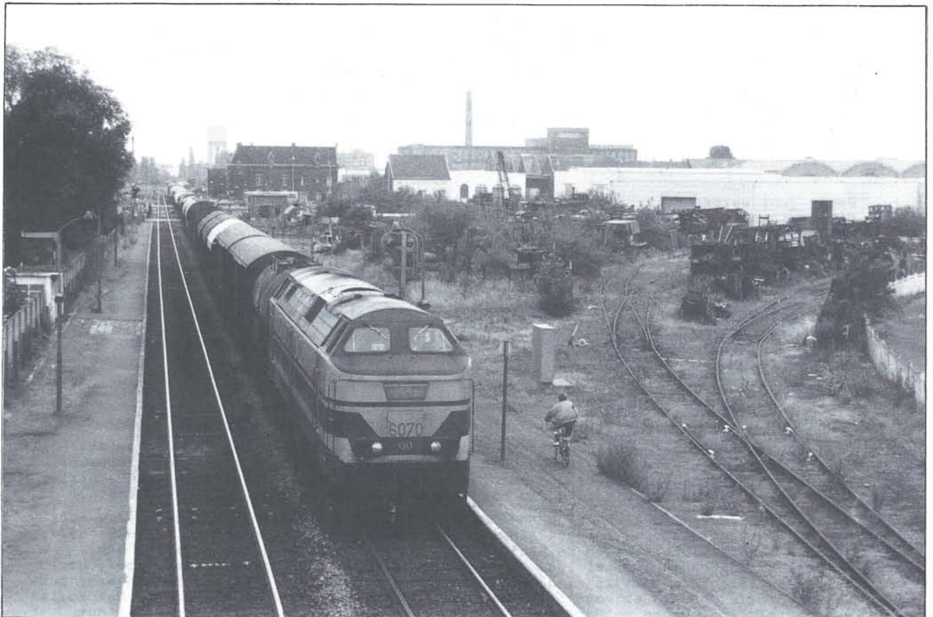
De 6070, één van de weinige nog in dienst zijnde diesellocs type 60/61, rijdt met een zware goederentrein langs de voormalige stopplaats Gent Muide. De loc is deze goederentrein gaan ophalen op de westelijke oever van het kanaal Gent - Terneuzen (lijn 55) en sleept deze nu naar het vormingsstation Gent Zeehaven. Gent Muide, 10.07.86.
